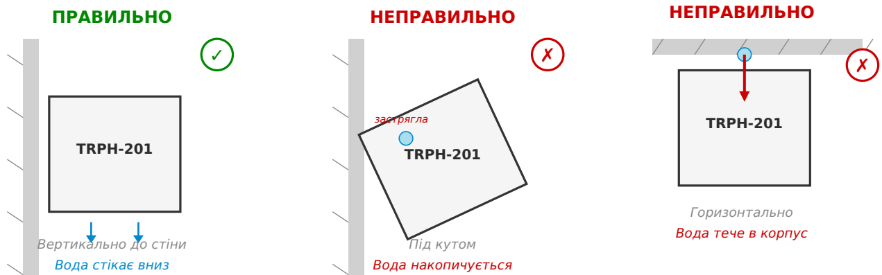
Рис. 4. Правильне й неправильне положення трансмітера при монтажі
