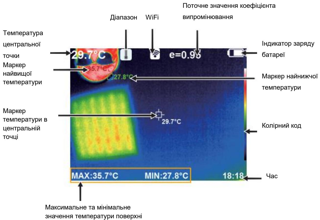
**Діапазон:** діапазон вимірювання температури.
