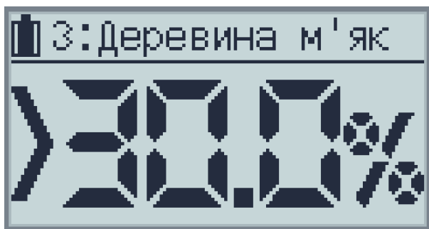
Рисунок 6 — Індикація виходу за діапазон (деревина, понад 30 %)
