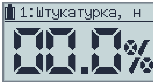
Рисунок 3 — Режим вимірювання (група 1, сенсор у повітрі)
