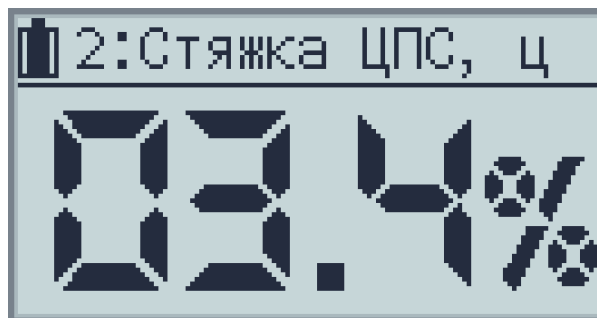
Рисунок 4 — Приклад вимірювання (стяжка ЦПС, 3,4 %)
