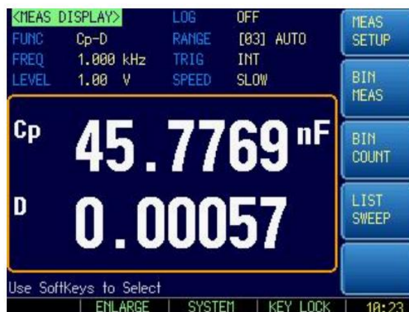
Рисунок 11-2 Результати випробувань конденсаторів
